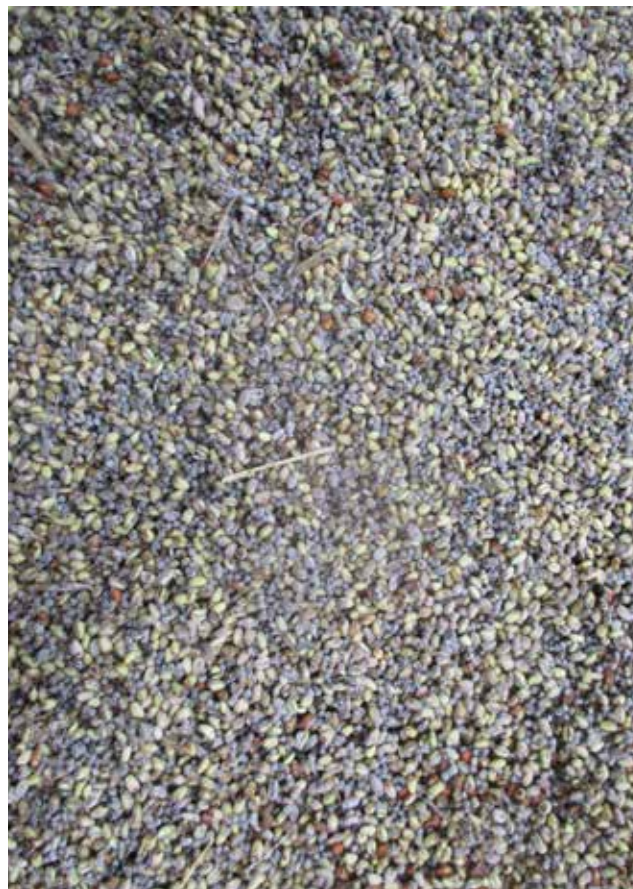
Abb. 4: Weiße Patina an der Oberfläche des gelagerten Sodagrains
